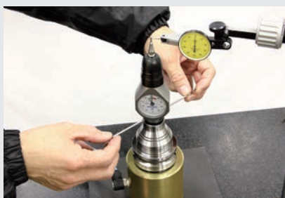
① 3Dテストをツールホルダでクランプして、振れを測定します。
