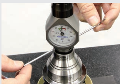
② 4箇所のスクリューにより、振れがゼロになるように調整してください。
