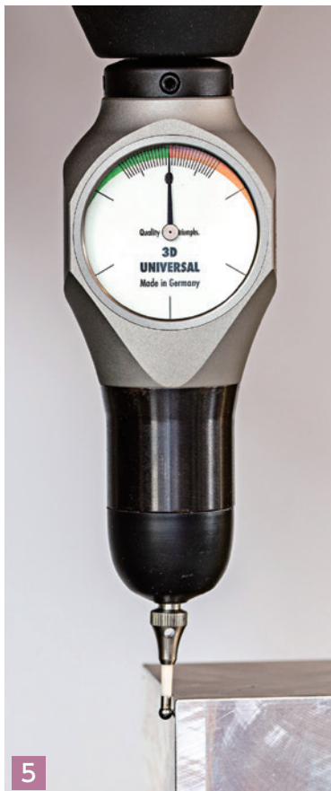
5 指針が再び正確に「0」を示した位置で停止してください。その位置が原点です。
